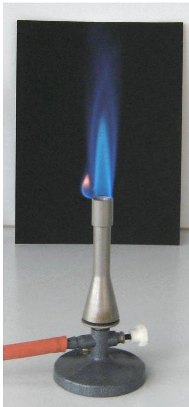
Ist die Luftzufuhr zu groß oder der Gasdruck zu klein, so schlägt der Brenner durch, das heißt, das Gas brennt im Innern des Brennerrohres an der Gasaustrittsdüse. In diesem Fall muss die Gaszufuhr sofort abgestellt werden. Nach dem Erkalten des Brenners stellt man dann die Luftzufuhr etwas kleiner oder vergrößert die Gaszufuhr.
