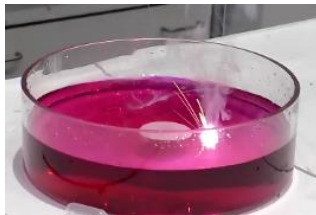
Na auf Filterpapier, „hüpft“ beim Verbrennen durch das Wasser
