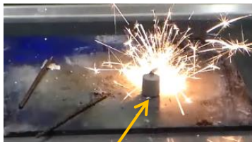
\text{LiAlH}_4 -Pellet wird mit Wunderkerze angezündet
