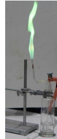
Cu-Wolle als Rückschlagsicherung
