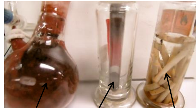
weißer Phosphor aufbewahrt unter Wasser, da an Luft selbstentzündlich und sehr giftig
