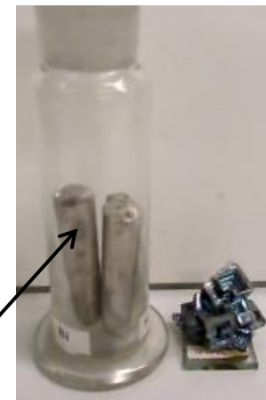
weißer Phosphor aufbewahrt unter Wasser, da an Luft selbstentzündlich und sehr giftig
