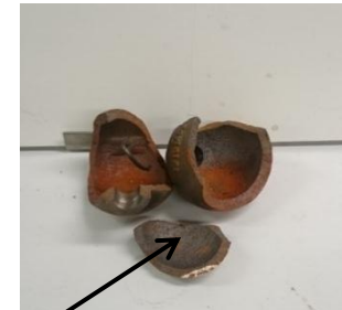
Stahlkugel in mehrere Teile zerplatzt
